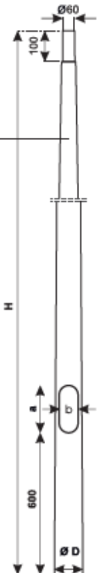
Słup oświetleniowy z kompozytu na fundamencie
